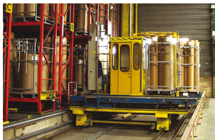
Positionnement de wagons à déplacement latéral
