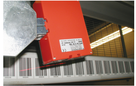
Positionnement de véhicules de manœuvre
