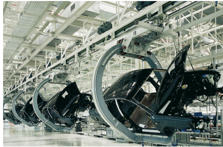
Positionnement de transporteurs aériens électriques dans l'industrie automobile
